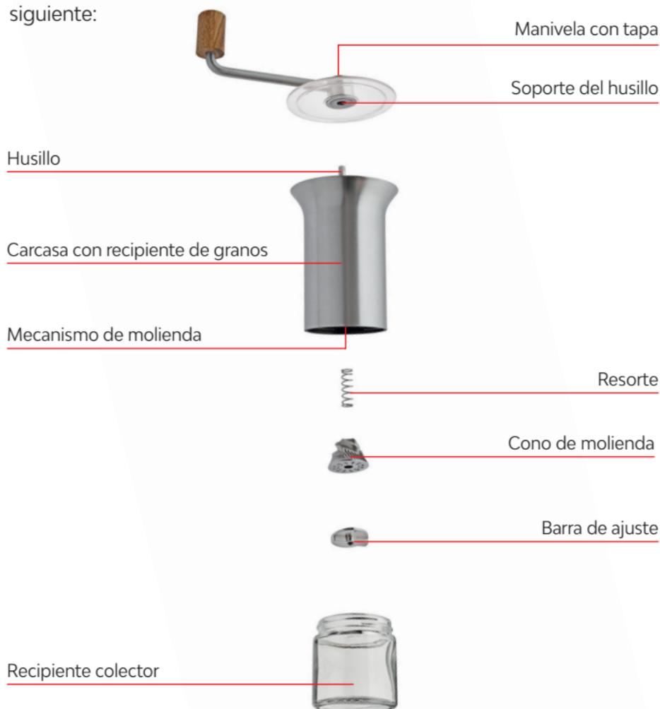
Desatornille el recipiente colector. Sujete la manivela con la tapa y dé la vuelta al molinillo. Gire la barra de ajuste en sentido contrario a las agujas del reloj hasta que se separe del molinillo y retírela. Retire el cono de molienda y el resorte.
