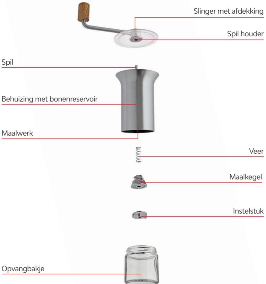
Schroef de opvangbakje los. Houd de slinger met deksel vast en draai de molen om. Draai de instelstuk tegen de klok in totdat deze loskomt van de molen en verwijder deze. Verwijder de maalkegel en de veer.
