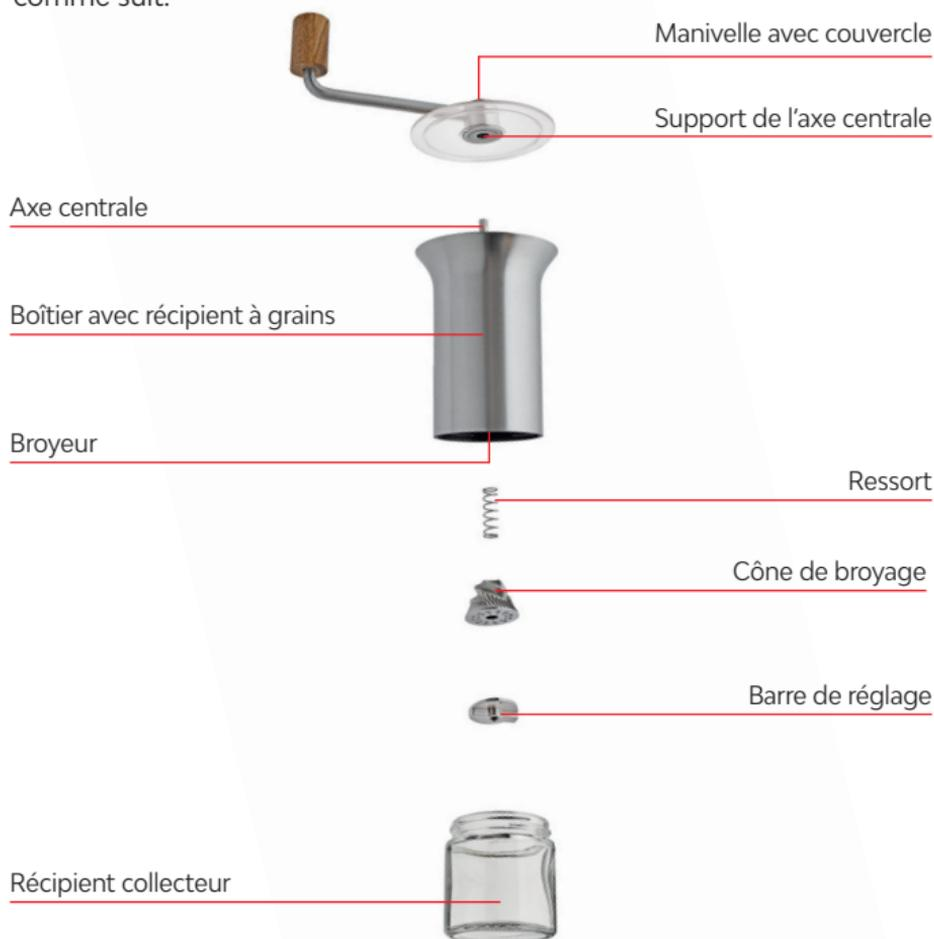
Dévissez le récipient collecteur. Tenez la manivelle avec le couvercle et retournez le moulin. Tournez la barre de réglage dans le sens inverse des aiguilles d'une montre jusqu'à ce qu'elle se détache du broyeur et retirez-la. Enlevez le cône de broyage et le ressort.
