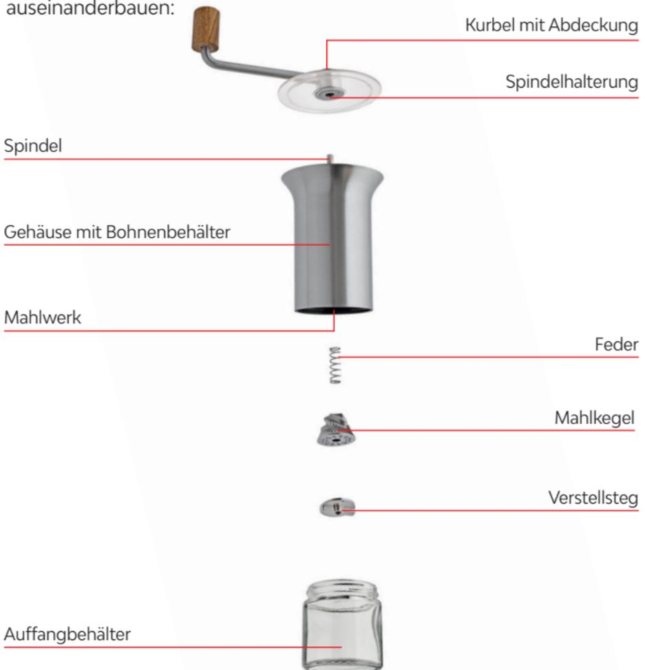
Schrauben Sie den Auffangbehälter ab. Halten Sie die Kurbel mit Abdeckung fest und drehen Sie die Mühle um. Drehen Sie den Verstellsteg gegen den Uhrzeigersinn, bis er sich vom Mahlwerk löst und nehmen Sie ihn ab. Entnehmen Sie Mahlkegel und Feder.
