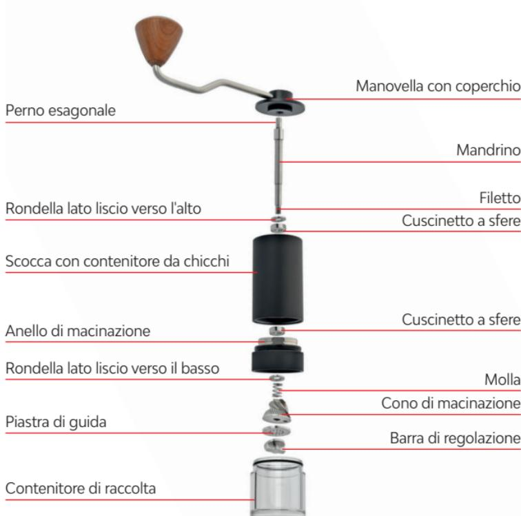
Rimuovere il contenitore di raccolta. Tenere la manovella con coperchio e capovolgere il macinino. Ruotare la barra di regolazione in senso antiorario fino a quando non si stacca dal meccanismo di macinazione e rimuoverla. Rimuovere tutti i componenti del meccanismo di macinazione. Svitare l'anello di macinazione in senso orario.
