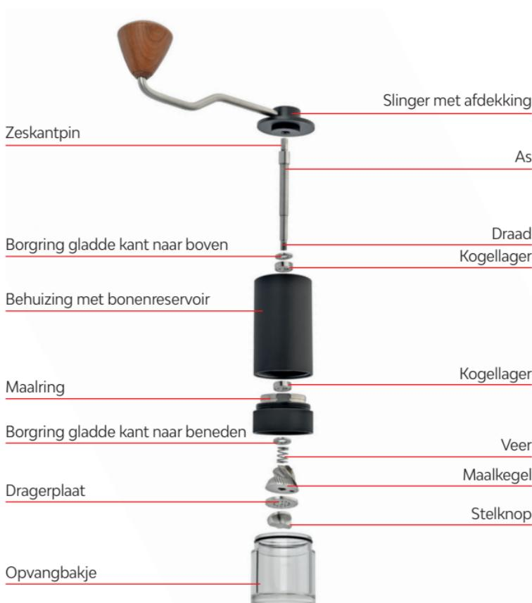
Verwijder het opvangbakje. Houd de slinger met deksel vast en draai de molen om. Draai het instelstuk tegen de klok in totdat deze loskomt van de molen en verwijder deze. Verwijder de dragerplaat, de maalkegel en indien nodig de veer en borring. Schroef de maalring met de klok mee los.
