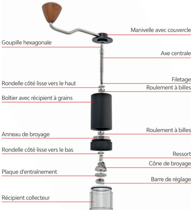
Retirez le récipient collecteur. Tenez la manivelle avec le couvercle et retournez le moulin. Tournez la barre de réglage dans le sens inverse des aiguilles d'une montre jusqu'à ce qu'elle se détache du broyeur et retirez-la. Enlevez tous les composants du mécanisme de broyage. Dévissez l'anneau de broyage dans le sens des aiguilles d'une montre.
