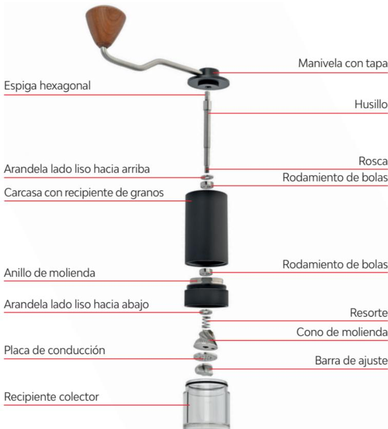
Retire el recipiente colector. Sujete la manivela con la tapa y dé la vuelta al molinillo. Gire la barra de ajuste en sentido contrario a las agujas del reloj hasta que se separe del molinillo y retírela. Retire todos los componentes del mecanismo de molienda. Desenrosque el anillo de molienda en el sentido de las agujas del reloj.
