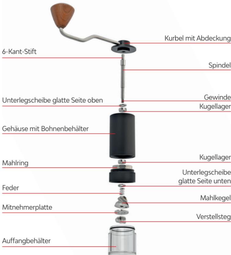
Nehmen Sie den Auffangbehälter ab. Halten Sie die Kurbel mit Abdeckung fest und drehen Sie die Mühle um. Drehen Sie den Verstellsteg gegen den Uhrzeigersinn, bis er sich vom Mahlwerk löst und nehmen Sie ihn ab. Entnehmen Sie die einzelnen Mahlwerkskomponenten. Schrauben Sie den Mahlring im Uhrzeigersinn ab.
